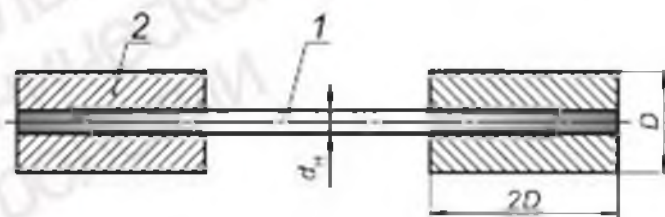
1 — отрезок стержня; 2 — испытательная муфта
